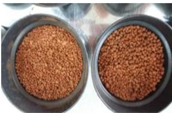
Gambar 1. Hidroton ukuran 4 mm tanpa menggunakan campuran *digestate*
