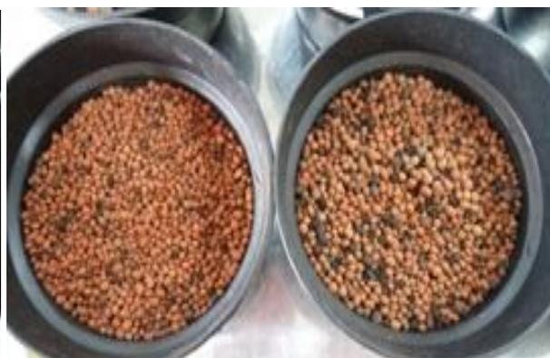
Gambar 2. Hidroton ukuran 4 mm dengan menggunakan campuran *digestate*
