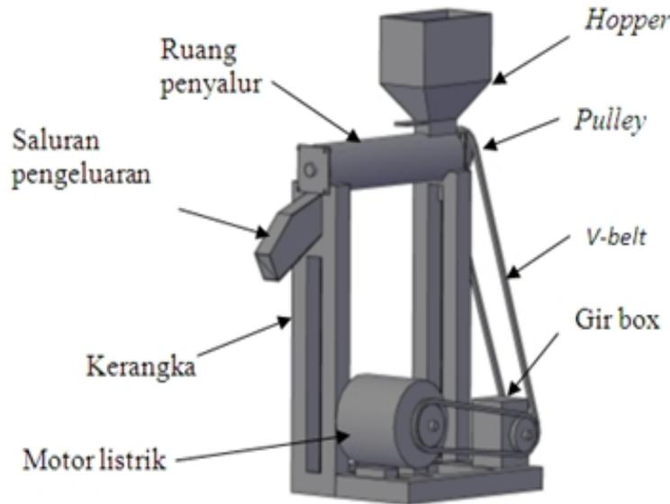
Gambar 2. Komponen utama dari *screw conveyor*
