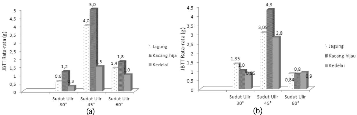
Gambar 9. Jumlah bahan tidak teralirkan a. kecepatan 40 rpm dan b. kecepatan 54 rpm
