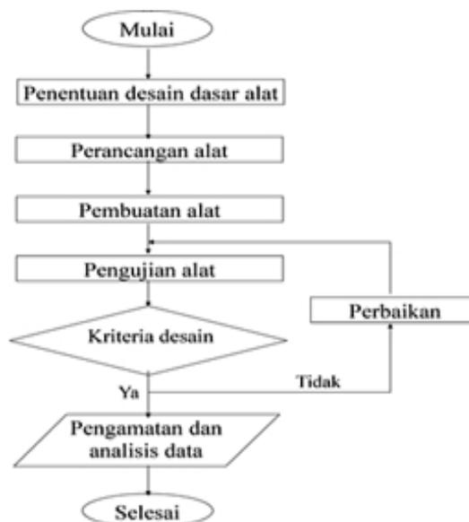
Gambar 1. Diagram alir pembuatan dan pengujian *screw conveyor*
