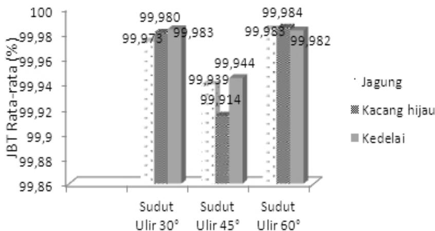
Gambar 8. Jumlah bahan teralirkan pada kecepatan 54 rpm
