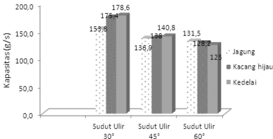
Gambar 10. Kapasitas pada kecepatan 40 rpm
