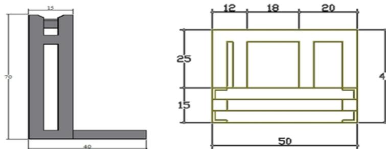
Gambar 3. Kerangka *screw conveyor* tampak samping dan atas beserta dimensi (cm)
