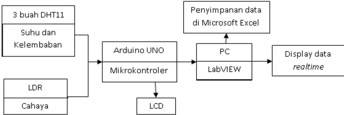
Gambar 1. Alur kerja rancang bangun sistem akuisisi data
