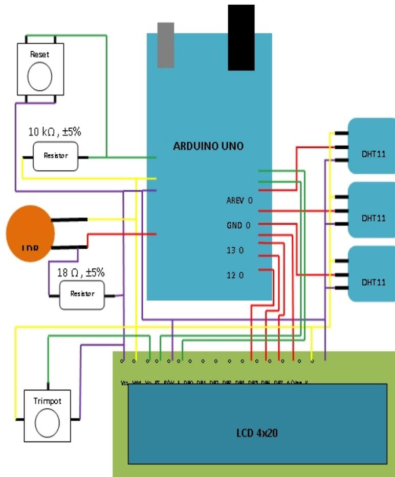
Gambar 2. Blok diagram sistem akuisisi data iklim mikro
