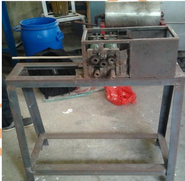
Gambar 2. Alat pengirat bambu
