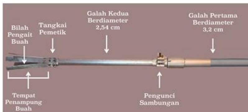
Gambar 5. Konstruksi Alat Pemanen Manggis
