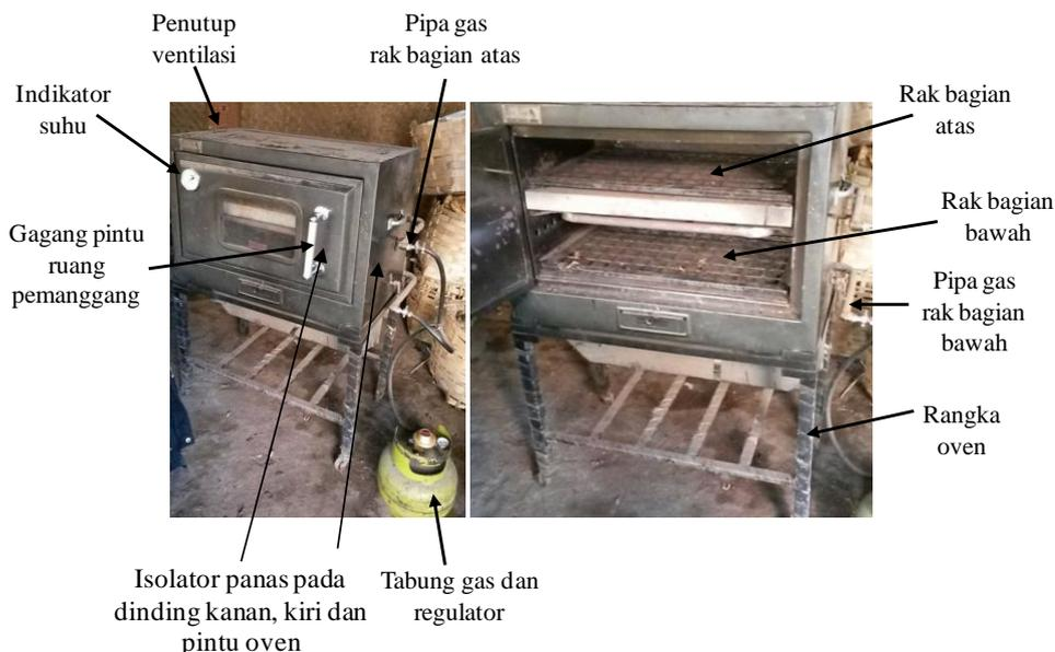
Gambar 1. Konstruksi Oven Pemanggang Ubi Cilembu
