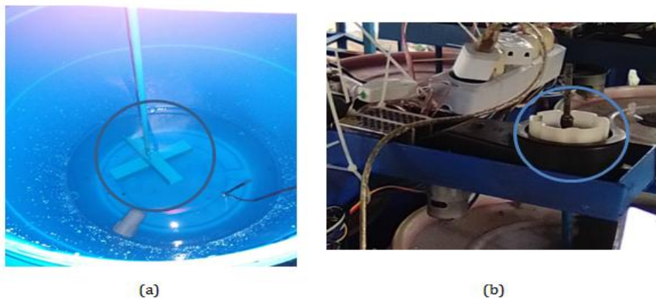
Gambar 4. (a) Aktuator Pengaduk dan (b) Motor Pengaduk Limbah
