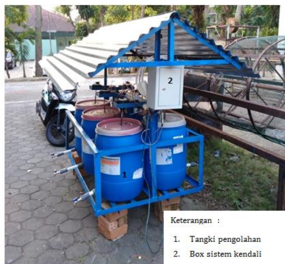
Gambar 1. Rancangan Bangun Sistem Pengolah Limbah Otomatis
