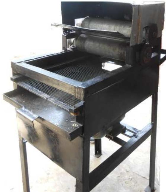
Gambar 3. Mesin perontok jali tipe roll silinder pejal
