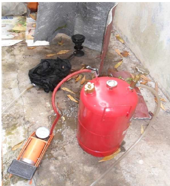
Gambar 1. a) Kompor mawar dan b) prinsip kerja kompor mawar
