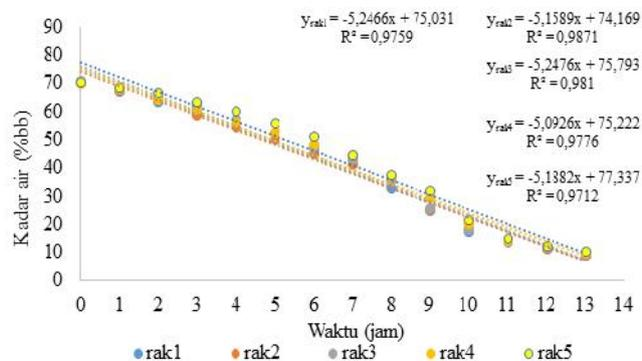
Gambar 7. Grafik rata-rata penurunan kadar air pengeringan menggunakan energi listrik dengan ketebalan 1mm - 2,9mm
