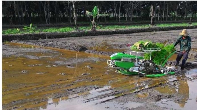
Gambar 1. Persiapan Rice Transplanter untuk operasional di lahan pasang surut tipe B, dengan kedalaman lumpur ± 27 cm
