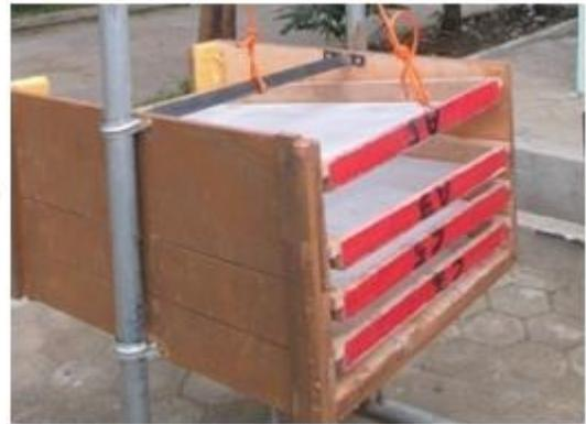
**Gambar 5.** Peletakan rak dengan rak keempat yang tidak terangkat
