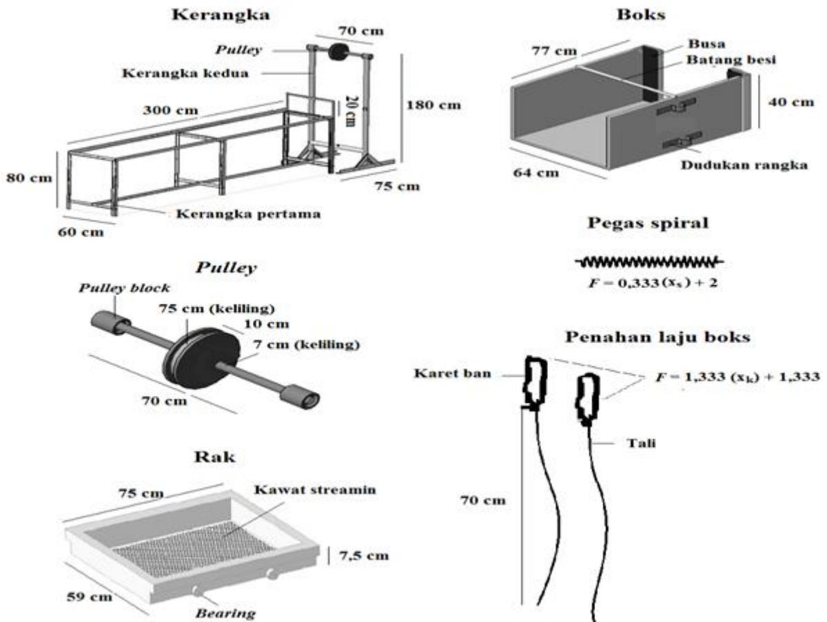
Gambar 2. Komponen alat penyusun rak penjemuran di atas para-para ke dalam boks secara semi mekanis.
