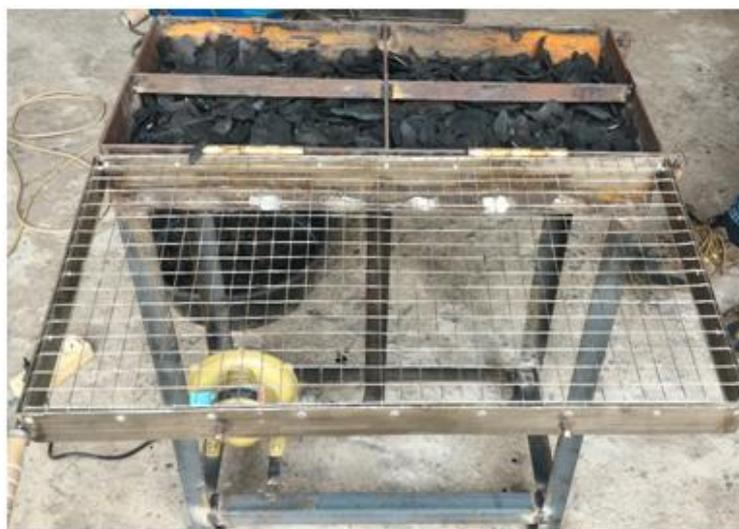
Gambar 2. Prototipe tungku panggang
