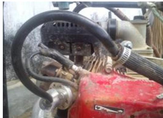
Gambar 3. Leher karburator universal dan sambungan selang ke stick kompor gas
