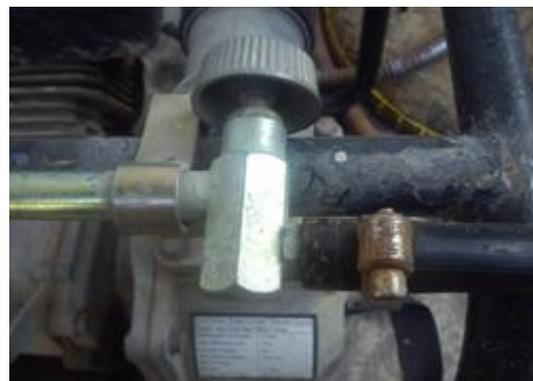
Gambar 4. Sambungan selang dari leher karburator ke stick kompor gas dan sambungan selang dari stick kompor ke *regulator high pressure*.
